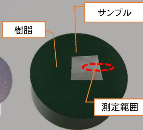
樹脂とサンプルの境界面に約800nmの段差とサンプルエッジにダレが生じてしまっている。
